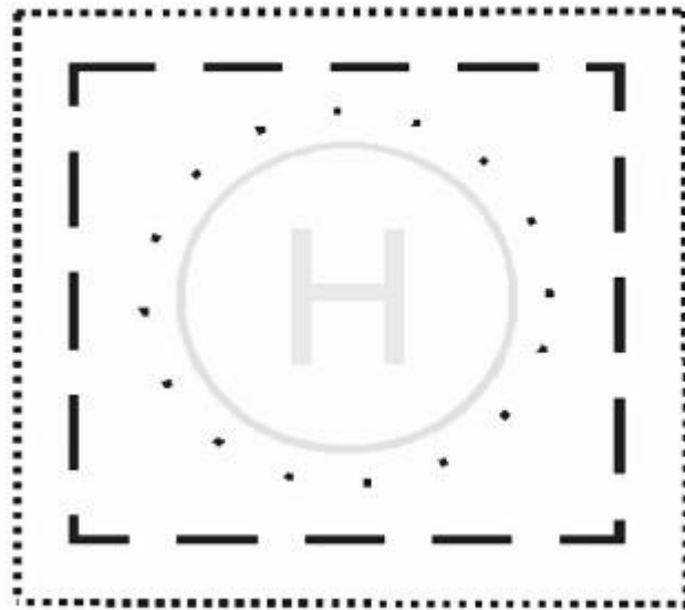
Прилог 3Ц : Свјетлосно обиљежавање TLOF
